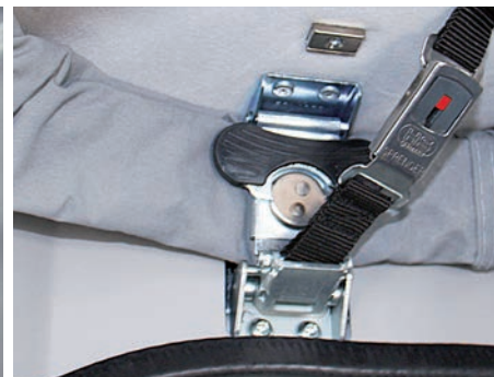
Verrouillage simple et sécurisé du toit avec deux fermetures Southco et une sangle de sécurité supplémentaire intégrée
