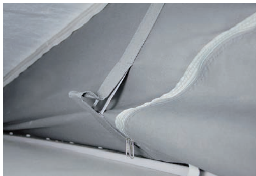
Le soufflet en tissu se rabat automatiquement vers l'intérieur grâce à un mécanisme de rabattement pratique lors de la fermeture de la coque.
