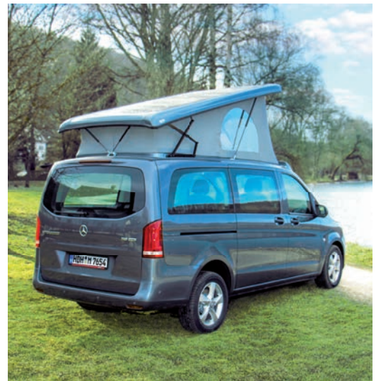
Des modules ou films solaires peuvent être apposées sur toute la surface extérieure lisse de la coque de toit.
