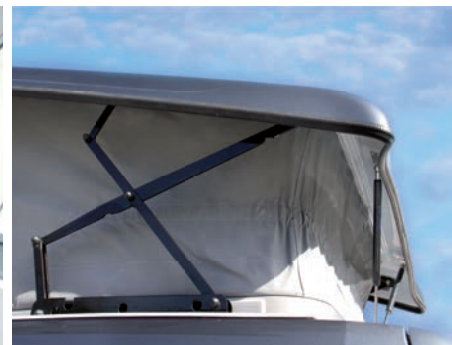
Les croisillons de 45 cm de hauteur créent de l'espace supplémentaire pour les jambes ou permettent de mettre la tête à l'arrière en dormant.
