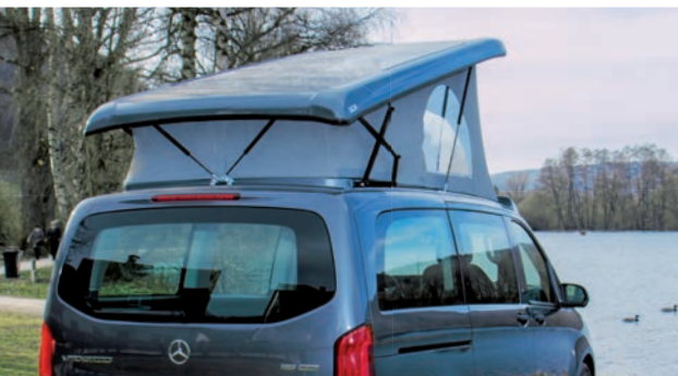
Installation facile grâce à deux croisillons et quatre vérins pneumatiques
