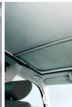
Couvercle en similicuir doublé du SCA 194 qui dissimule le soufflet en tissu replié quand le toit est fermé.
