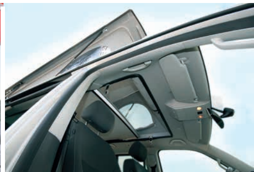
On accède à la couchette dans le toit installé à travers l'ouverture d'accès située au-dessus des sièges avant pour les toits relevables.
