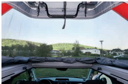
Soufflet en tissu Skyline du SCA 290 dans un design moderne monochrome et bicolore avec fenêtre panoramique intégrée.
