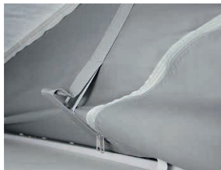
Mécanisme de rabattement sur tous les toits qui tire le soufflet automatiquement vers l'intérieur à la fermeture de la coque.
