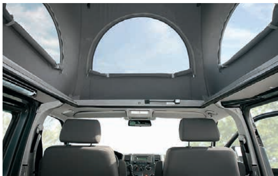
Soufflet en tissu standard avec trois fenêtres
