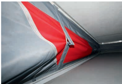
Le mécanisme de rabattement tire le soufflet automatiquement vers l'intérieur à la fermeture de la coque du toit.
