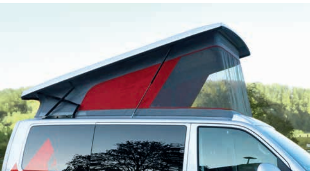
Installation facile grâce à deux croisillons et quatre ressorts à gaz.
