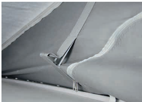
Le mécanisme de rabattement tire le soufflet automatiquement vers l'intérieur à la fermeture de la coque du toit.
