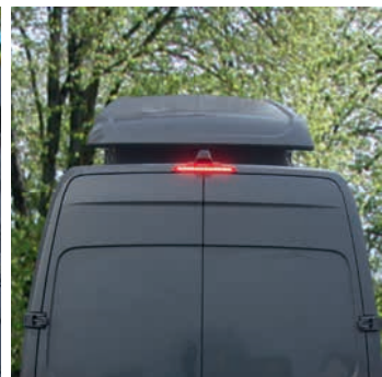
Des modules et des films solaires peuvent être installés sur la surface extérieure lisse de la coque du toit.
