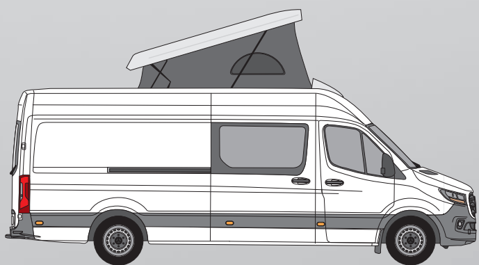
SCA 252 à partir d'une longueur de véhicule de 5,93 mètres avec toit surélevé de série
