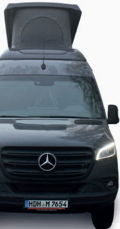
Rattachement aérodynamique du spoiler de toit en PRV au véhicule porteur.
