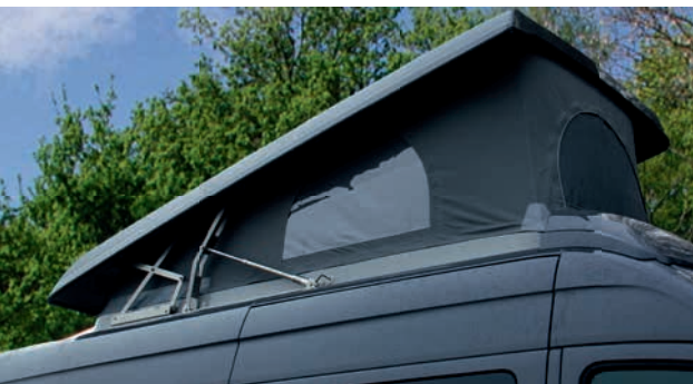
Installation facile et simple du toit grâce à deux hauts croisillons et quatre ressorts à gaz.
