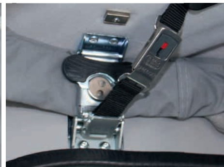
Verrouillage facile et sûr du toit au moyen de deux fermetures Southco et de courroies de sécurité supplémentaires intégrées.
