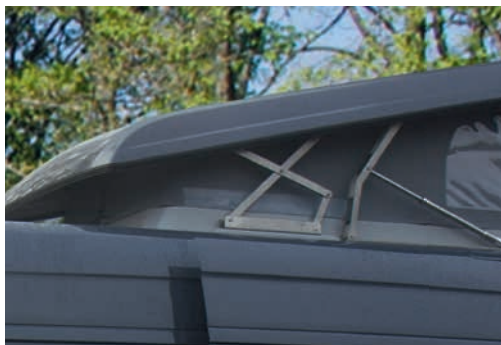
Les croisillons de 45 cm de haut offrent une grande liberté de mouvement pour les jambes et permettent de dormir avec la tête tournée vers l'arrière.
